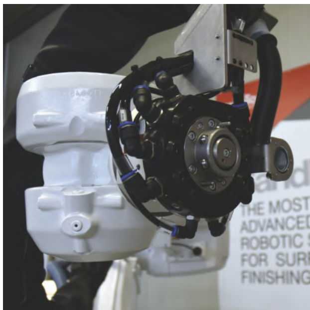
Per la fase di cambio utensile, SandRob beneficia delle prestazioni offerte dal sistema di cambio rapido Sws Schunk.
