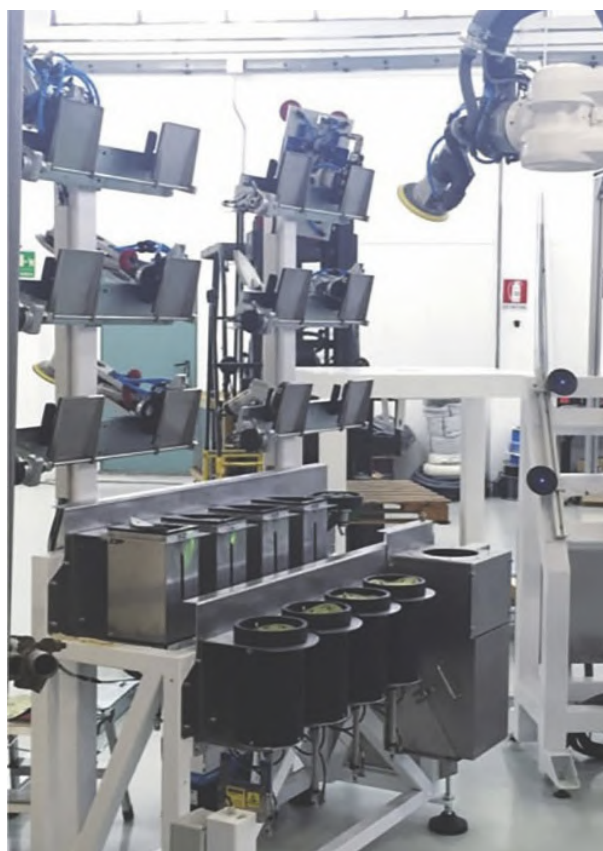
Dettaglio sistema brevettato di cambio end-effector e cambiocarta automatico con magazzini dedicati di SandRob.
